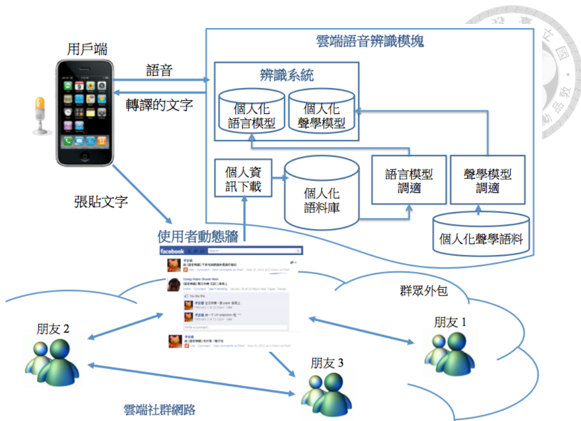
Figure 3.2: 以語音為接口的社群網路瀏覽器系統架構
